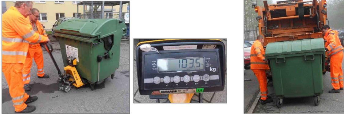
Foto 7: Verwiegung eines 1,1 m 3 MGB und Stichprobenentleerung in das Sammelfahrzeug
