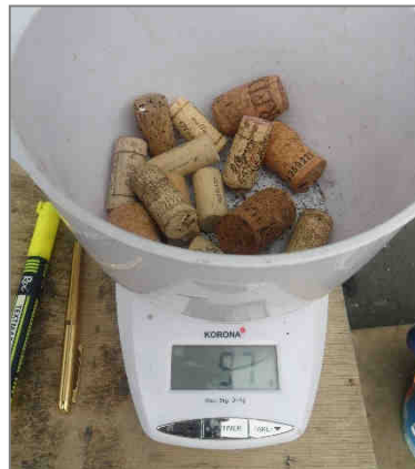
Foto 18: Wägung leichter Sortierfraktionen mittels Haushaltswaage (Toleranz \leq 0,001 kg)
