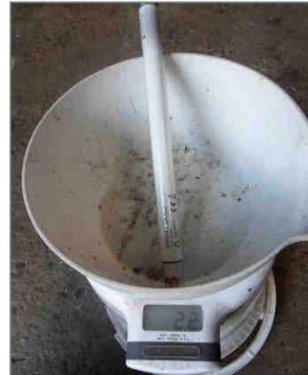
Foto 18: Wägung leichter Sortierfraktionen mittels Haushaltswaage (Toleranz \leq 0,001 kg)
