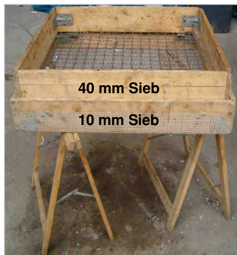
Foto 10: Sortiertechnik mit Grob- (40 mm) und Feinmüllsieb (10 mm)
