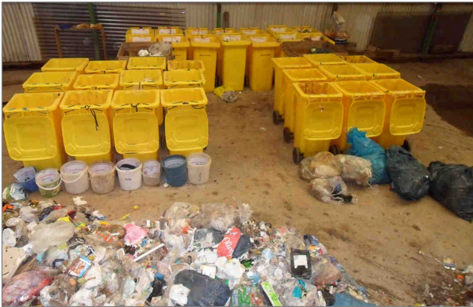
Foto 11: Anordnung der Sortierstationen und mit Tonnenzetteln versehene Sortierbehälter
