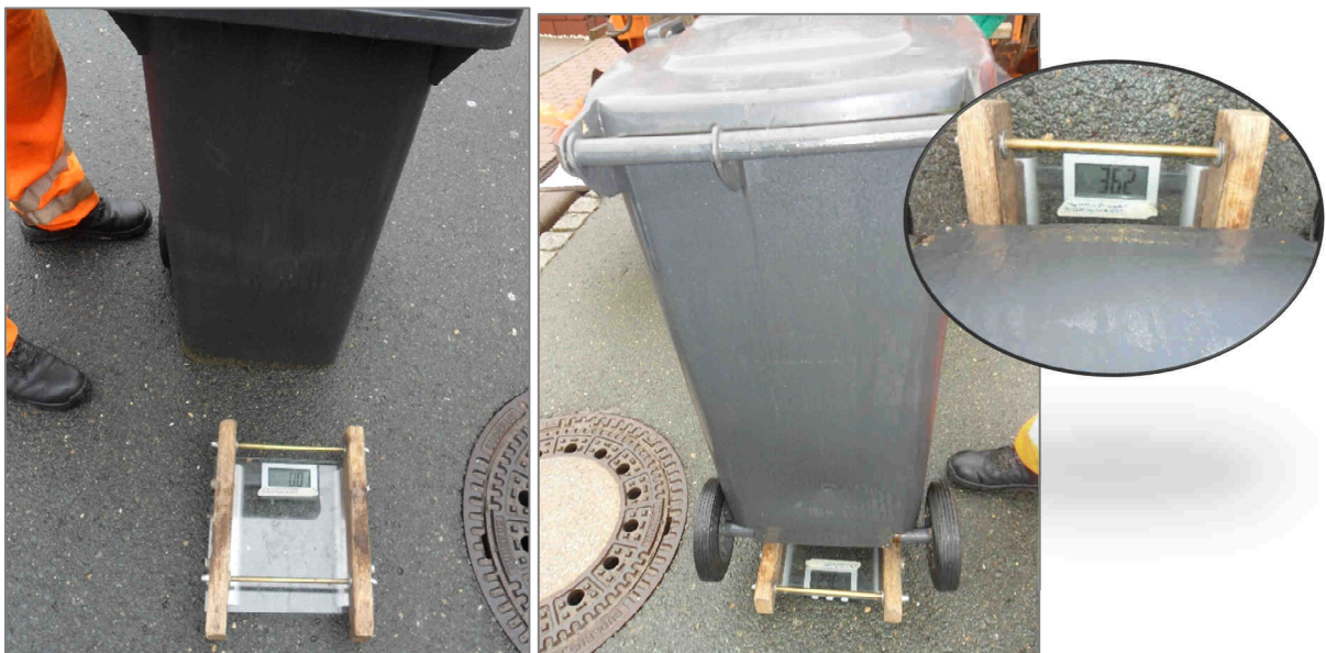
Foto 5: Bestimmung des spezifischen Raumgewichtes eines 120 l Stichprobenbehälters
